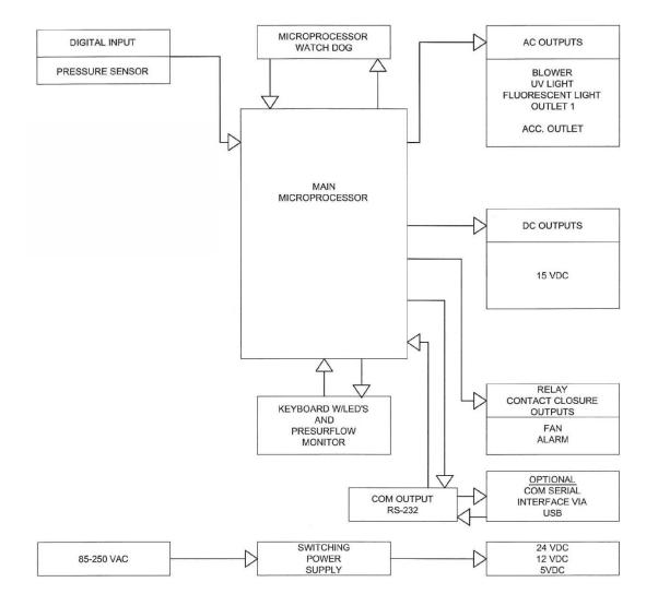
AEROMAX CONTROL SYSTEM BLOCK DIAGRAM
