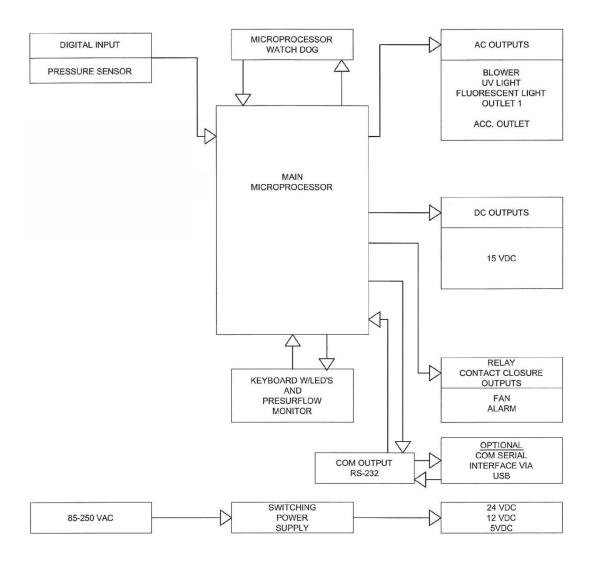
AEROMAX CONTROL SYSTEM BLOCK DIAGRAM
