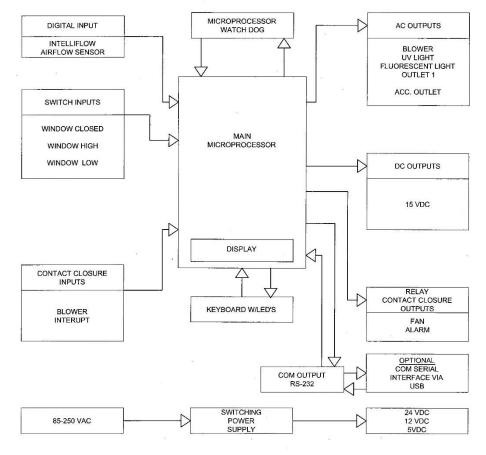
AEROMAX CONTROL SYSTEM BLOCK DIAGRAM
